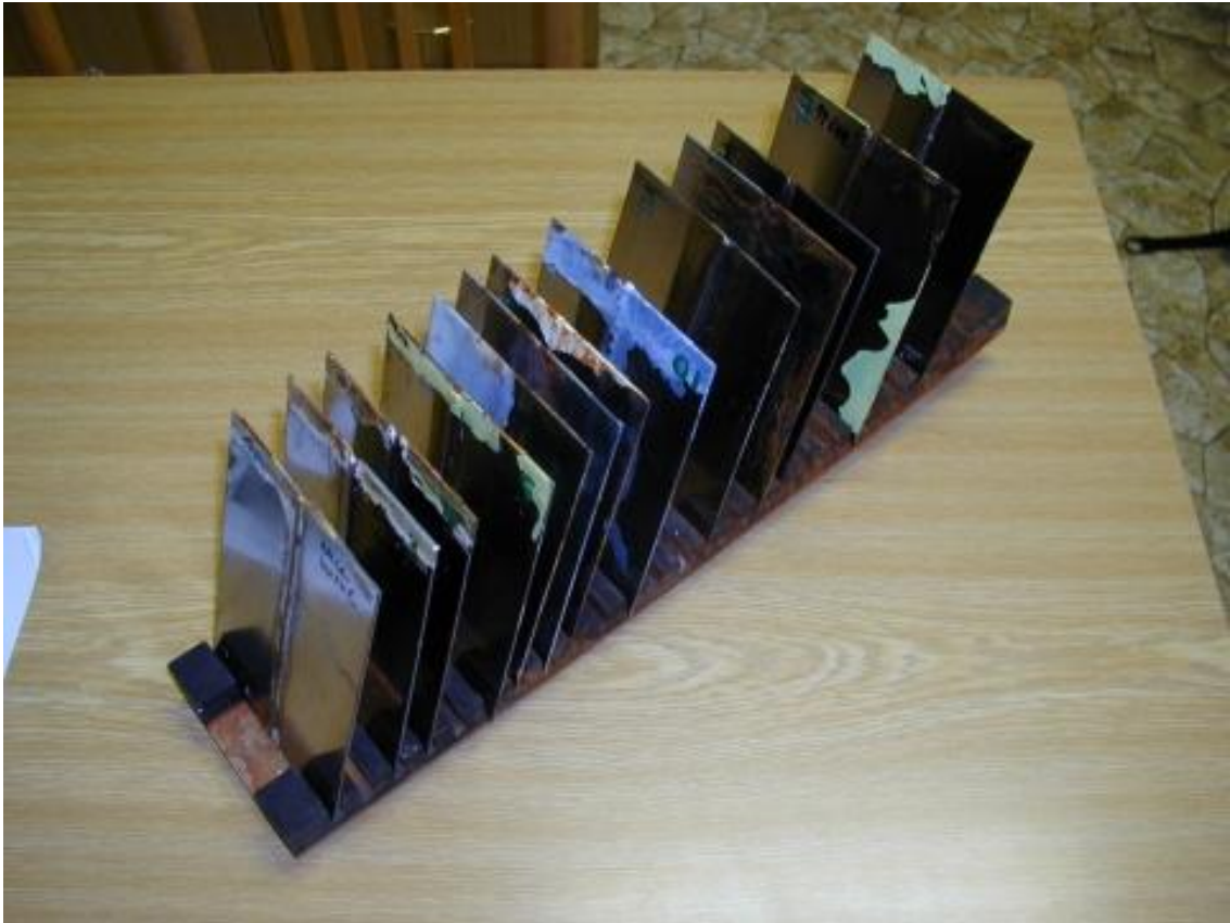
Obr. 14 Vzorky po vytažení korozní komory
