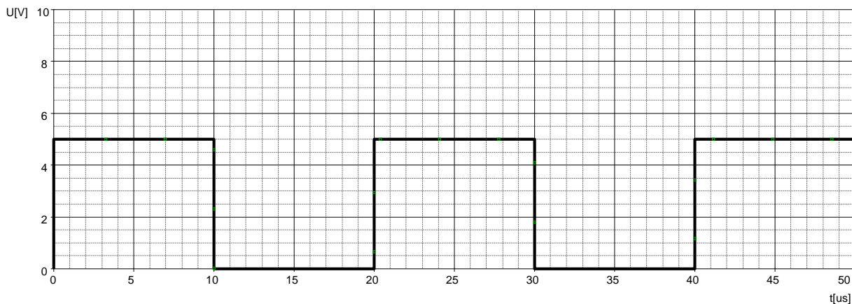
Obr. 10.2.1 - Časový průběh digitálního signálu na výstupu z vysílače
