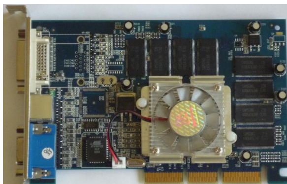
Obrázek 48 – Nvidia GeForce4 MX 440
