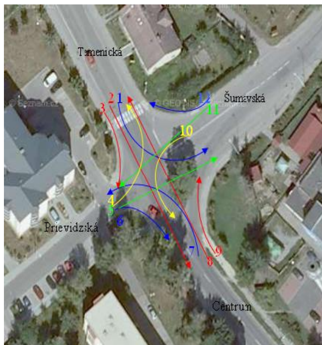
Obrázek 11 Schéma křižovatky se stupni podřazenosti jednotlivých dopravních proudů
