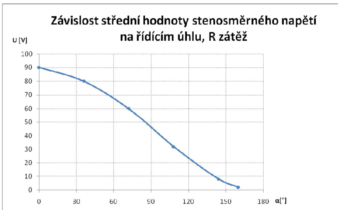
Obr. 36 - řídící charakteristika jednopulzní usměrňovače, R zátěž
