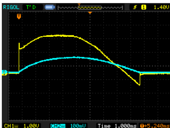
Obr. 40 Ě Pr b hy jednopulzní usm r ova , RL zát ě, \alpha=30^\circ , T/2
