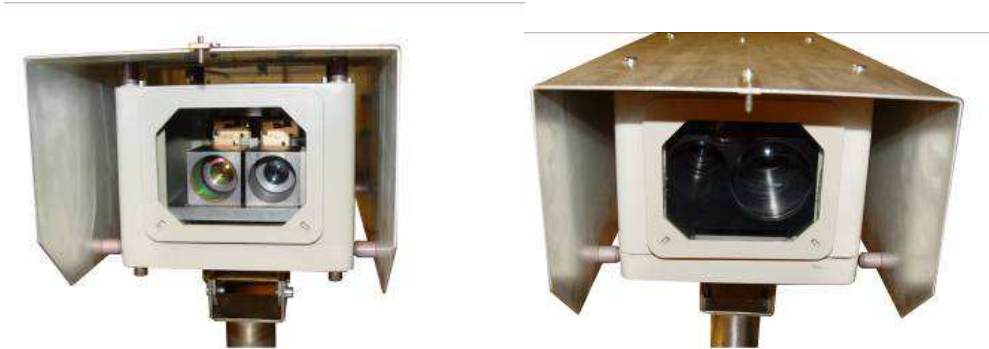
Obr. 7 – Optický vysílač a přijímač (vpravo) - Vyroben na VUT Brno
