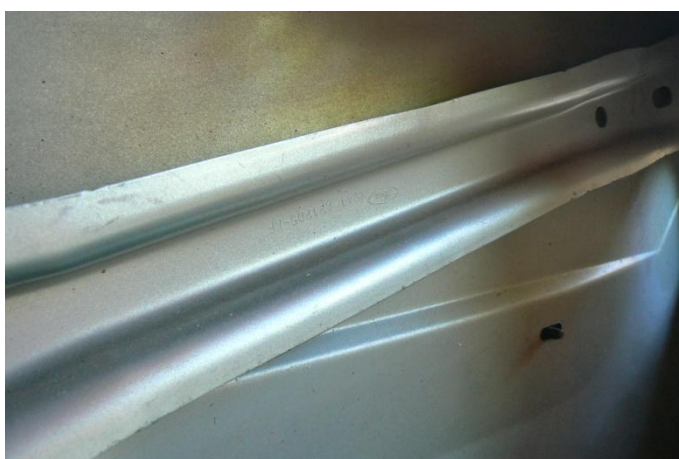
Příloha č. 8 – Jednotrapézový tvar boční výztuhy (Ford Focus)
