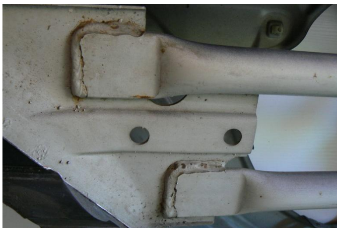
Příloha č. 6 – Ukázka připevnění výztuhy k rámu dveří svarem (Opel Astra)
