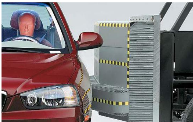
Obr. č. 7 – Crash test v reálném provádění – boční náraz [8]
