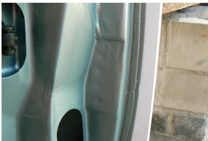
Příloha č. 7 – Ukázka připevnění výztuhy k rámu dveří bodovým svarem (Ford Focus)
