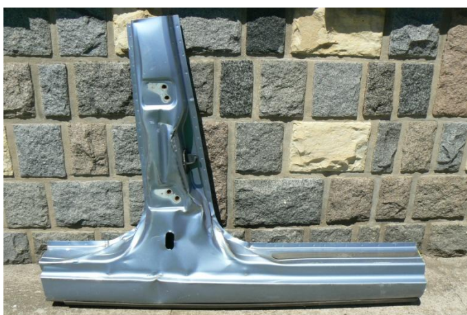
Příloha č. 11 – Díl z vozidla Ford C-Max poškozený bočním nárazem
