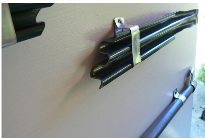
Příloha č. 10 – Dvoutrapezový tvar boční výztuhy (Ford Fusion)
