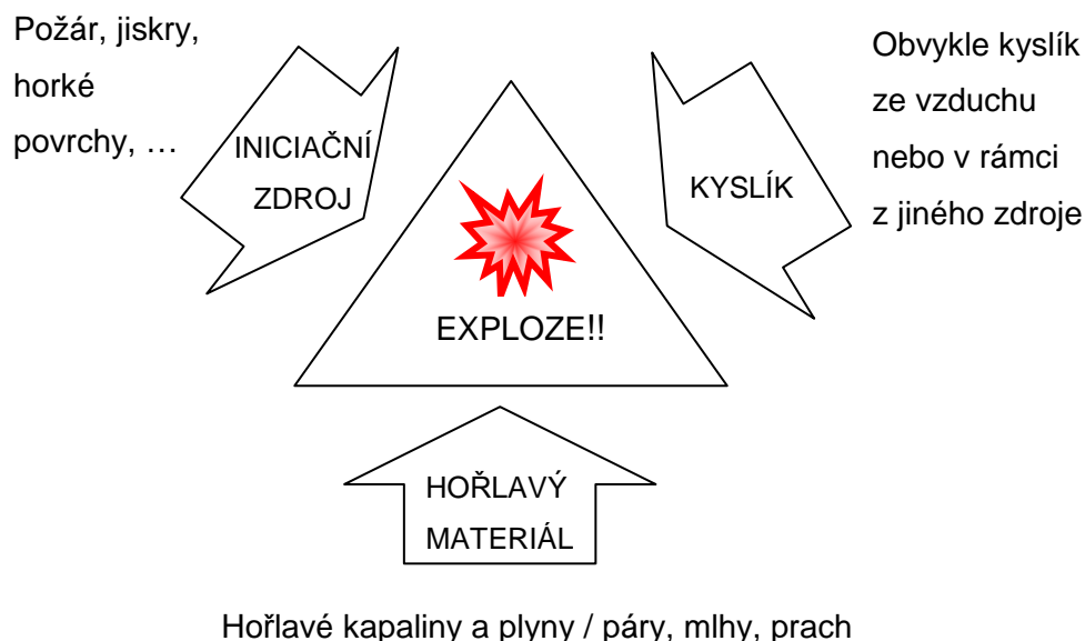
Obr. 1: Princip výbuchového trojúhelníku pro možný vznik exploze
