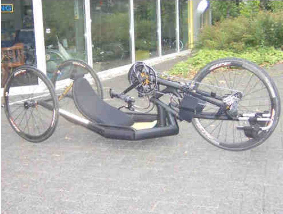
Obr. 6 Závodní silniční handbike z duralu a vláknových kompozitů na bázi uhlíku [5]
