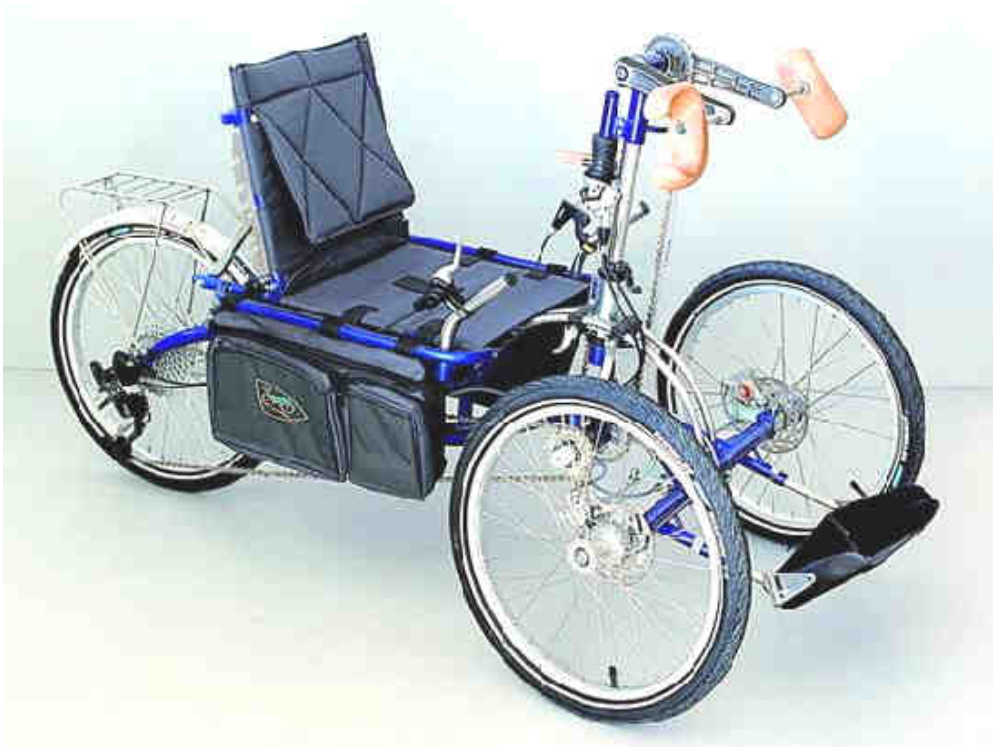
Obr. 7 Handbike s předními rejdrovými koly a jedním zadním poháněným kolem [6]
