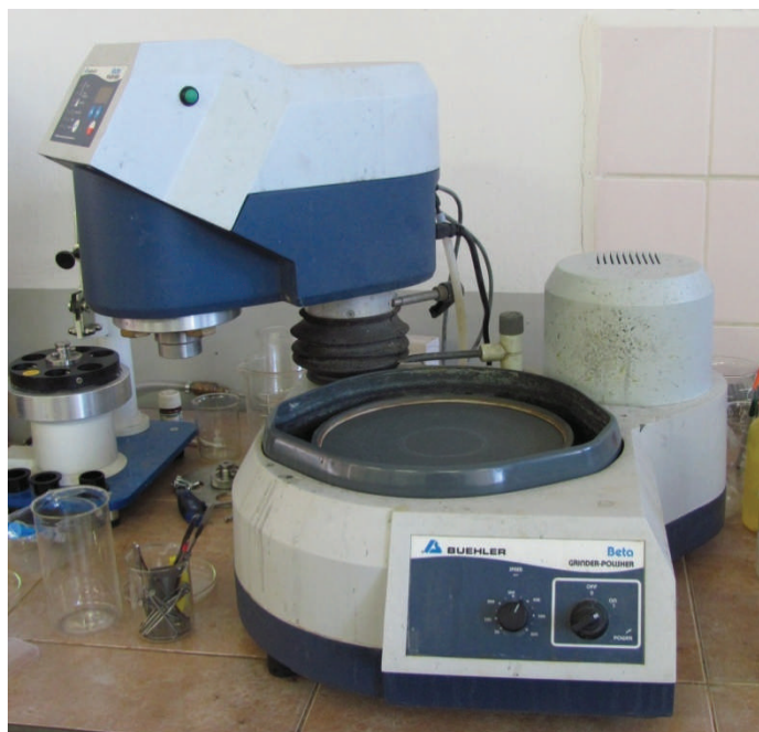
Obrázek 10: Bruska Buehler Beta v laboratoři DFJP
