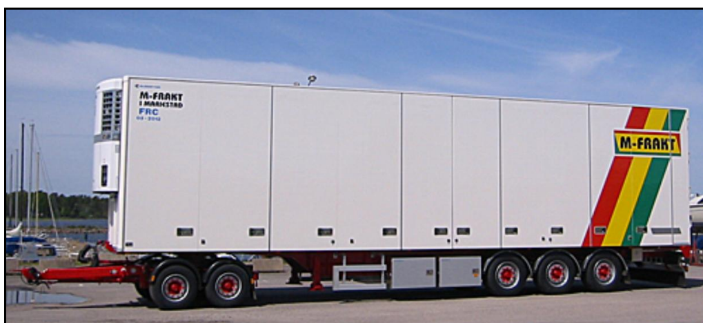
Obr. 7 Sedlový návěs na dvounápravovém točnicovém podvozku dolly
