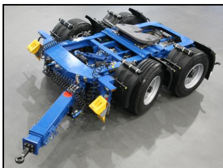
Obr. 15 Točnicový podvozek dolly s říditelnou první nápravou
