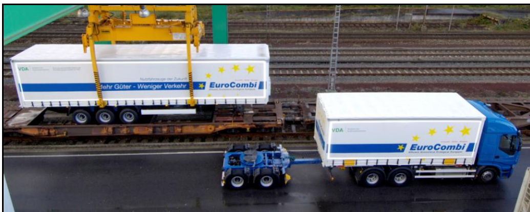
Obr. 3 Nákladní automobil s podvozkiem dolly a vertikálně manipulovatelným návěsem
