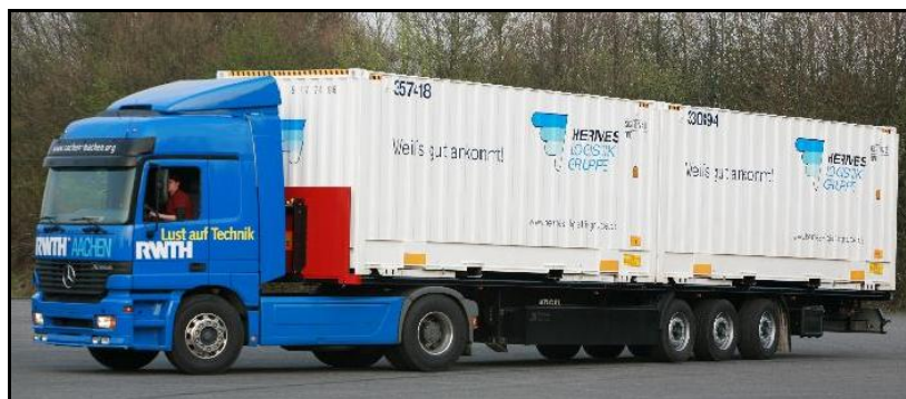
Obr. 12 Tahač s návěsem Eurotrailer pro přepravu výměnných nástaveb
