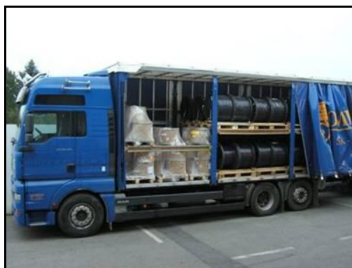
Obr. 4 Příklad variability druhé podlahy v nákladním automobilu
