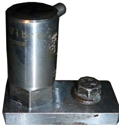
Obrázek 11: Přichycení snímače ke kovové podložce
