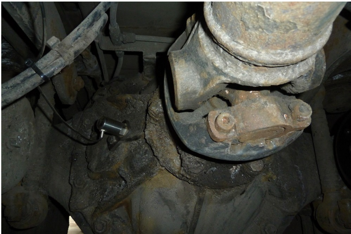
Obrázek 13: Upevnění snímače na diferenciálu - pohled ze strany
