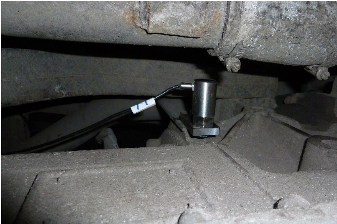
Obrázek 12: Upevnění snímače na motoru - pohled zdola
