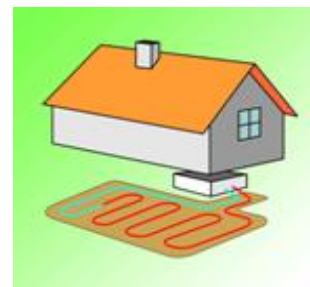
Obr. 5 Čerpadlo se zemním kolektorem
