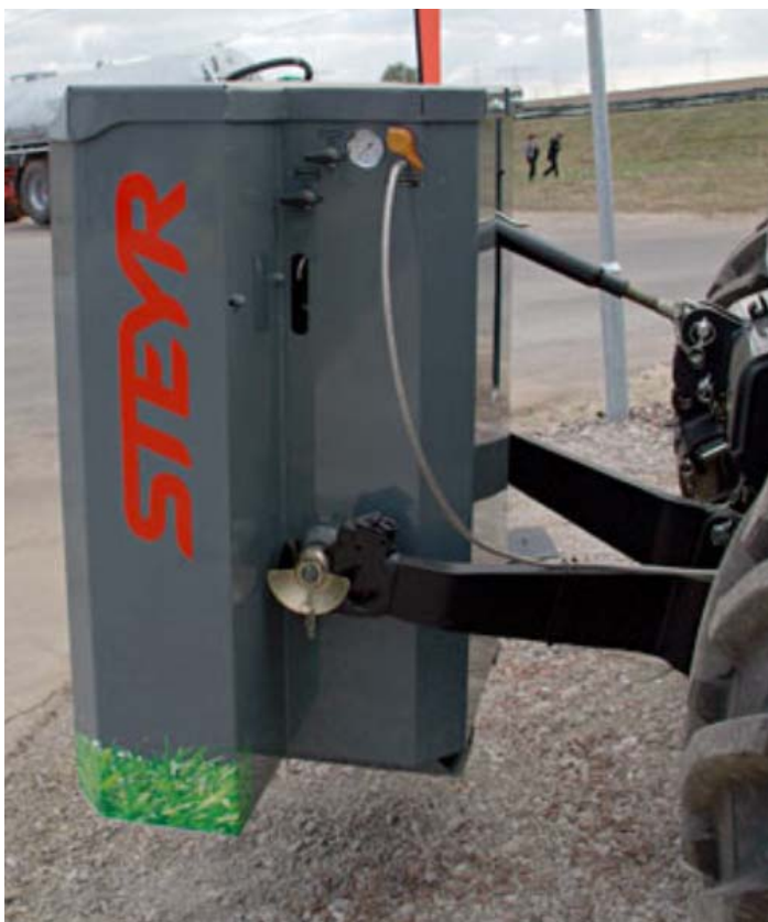
Obrázek 18 - Nádrž biometanu na předním nosiči nářadí
