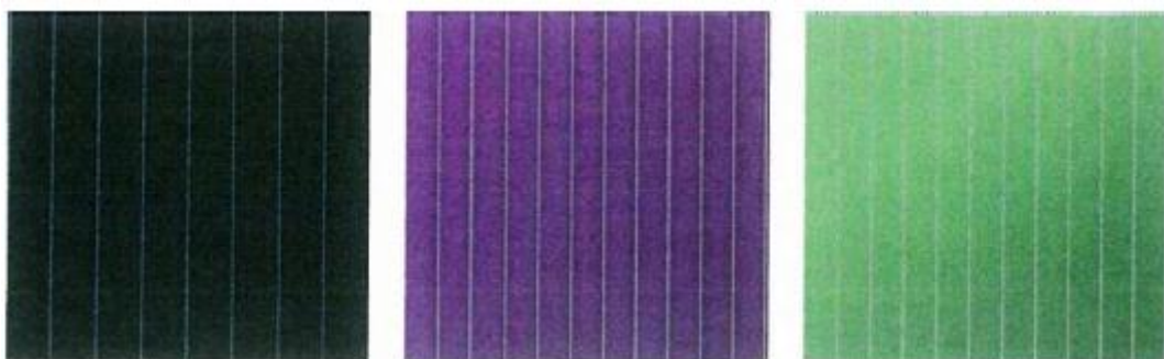
Obr. 1.21 Zleva: CIS solární články, články z amorfniho křemíku, CdTe solární články [11]
