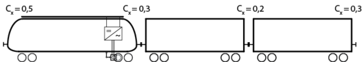
Obr. 4.1 Souprava s lokomotivou s fotovoltaickými panely
