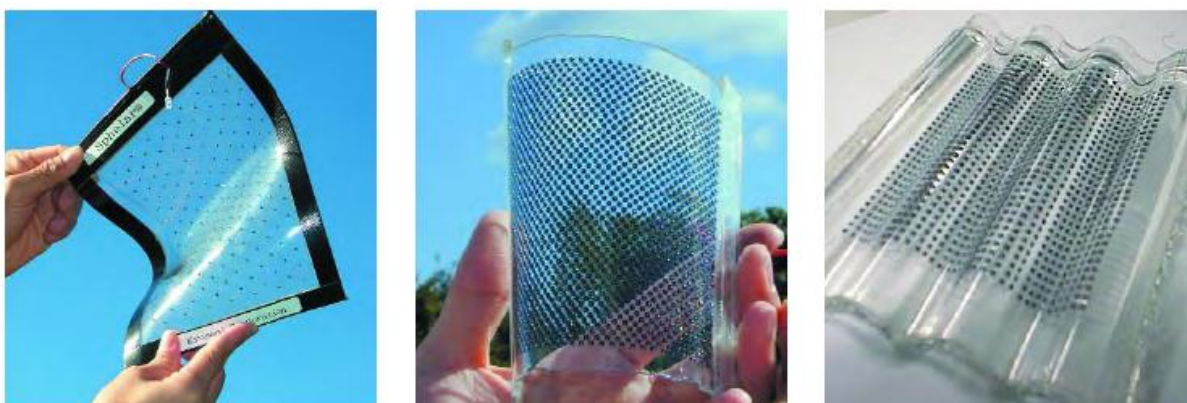
Obr. 1.25 Prototypy flexibilních sférických fotovoltaických modulů [11]
