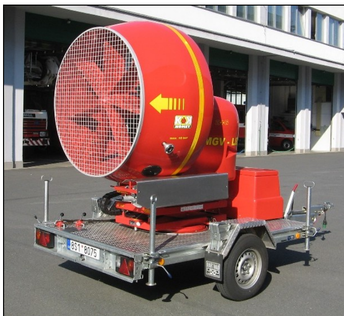
Obr. 4 Odlehčená šestilistá kompozitová vrtule
