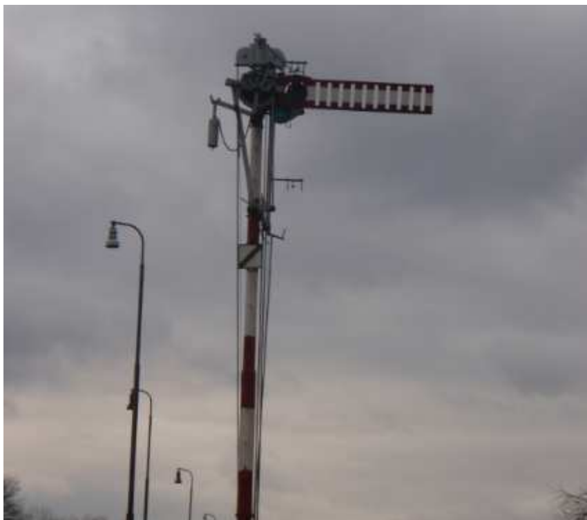
Obr. 34 Mechanické odjezdové návěstidlo
