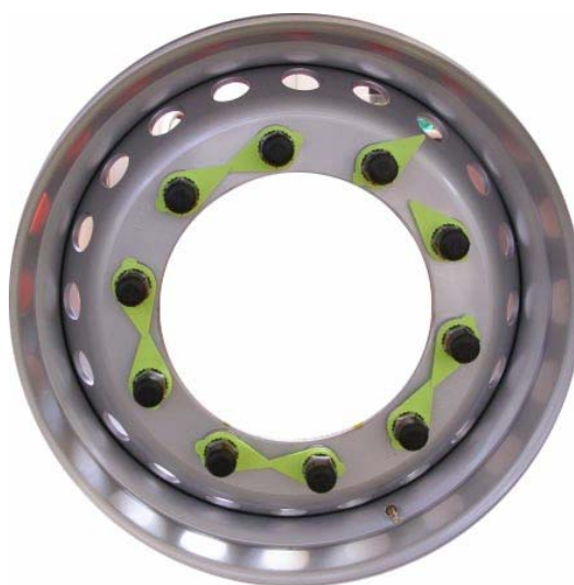
Obrázek č. 10: Rozložení matkových indikátorů na disku kola
