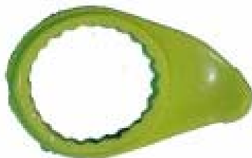
Obrázek č. 9: Tepelně zdeformovaný indikátor
