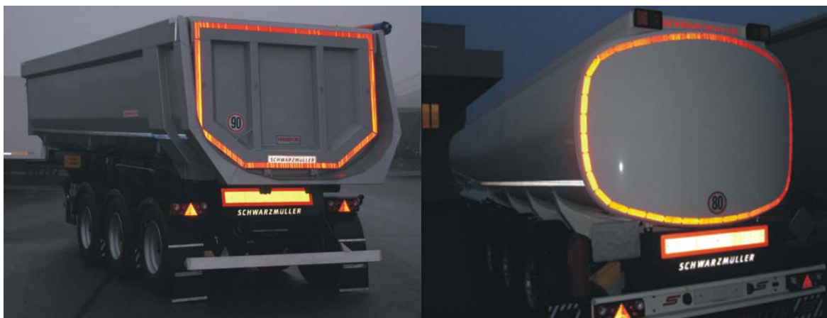
Obrázek č. 12: Příklad reflexního značení na návěsu schwarzmüller
