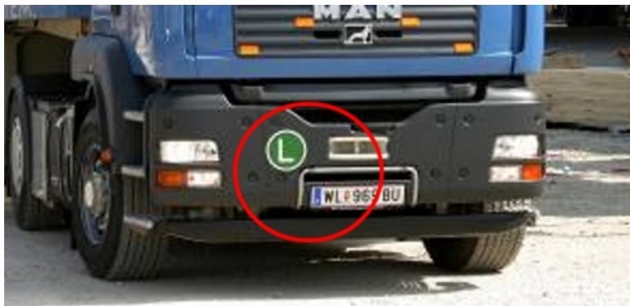
Obrázek č. 14: Označení vozidla se sníženou hlučností
