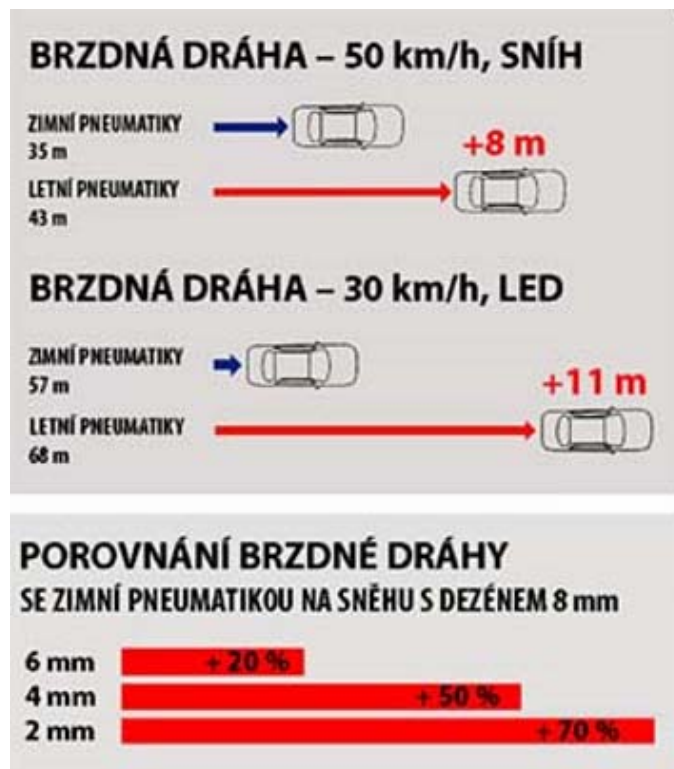
Obrázek č. 7: Porovnání délky brzdné dráhy u letní a zimní pneumatiky zdroj: (22)
