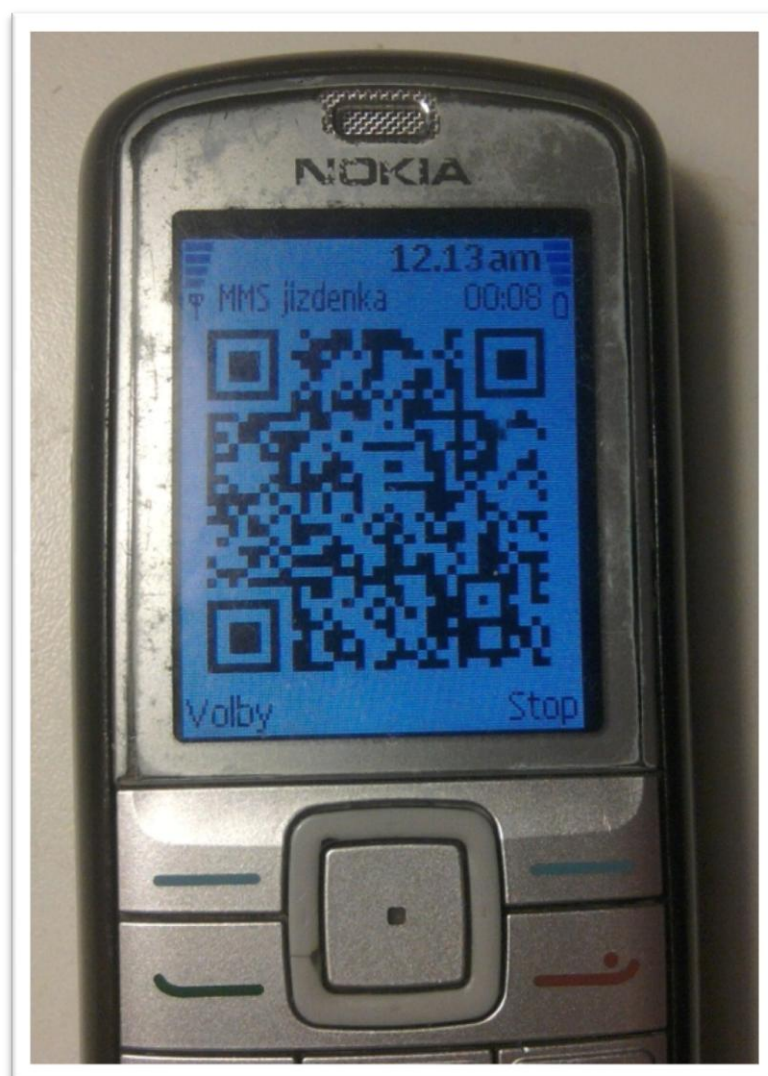
Obrázek 7 MMS s QR kódem na telefonu Nokia 6070 (představen v únoru 2006) zdroj: Autor
