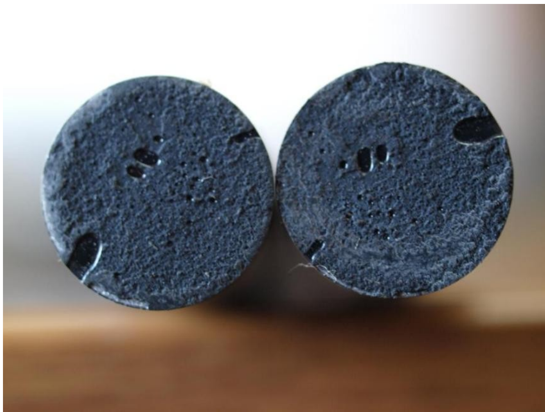
Obr. 5.10 Prasklý vzorek B, pohled na stykovou plochu
