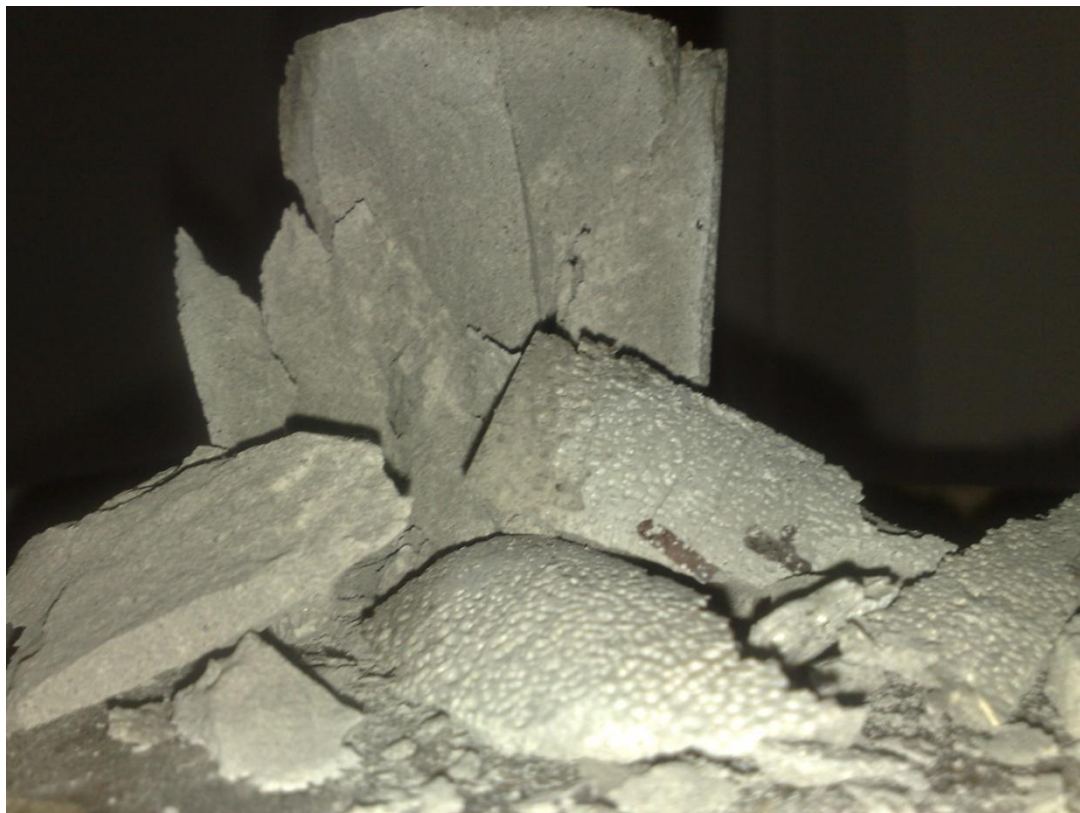
Obr. 14 – Zkouška pevnosti v prostém tlaku – Rozdrcený vzorek
