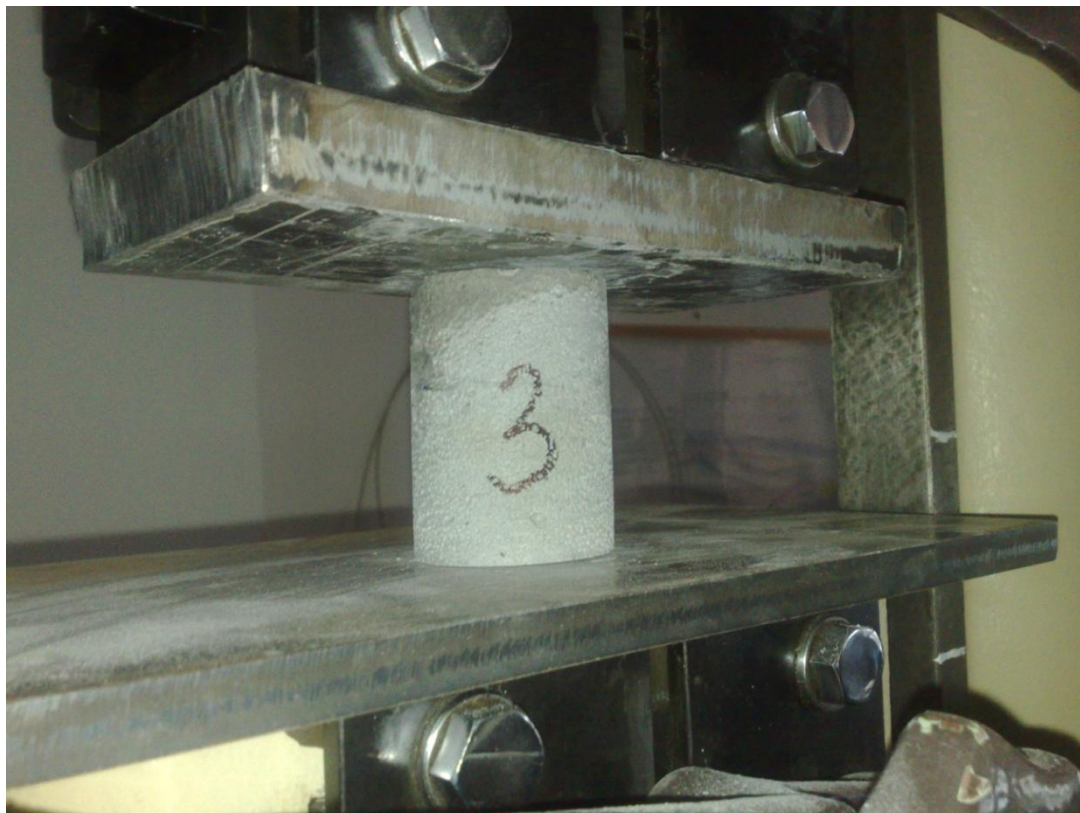
Obr. 13 – Zkouška pevnosti v prostém tlaku – Usazení v lisu
