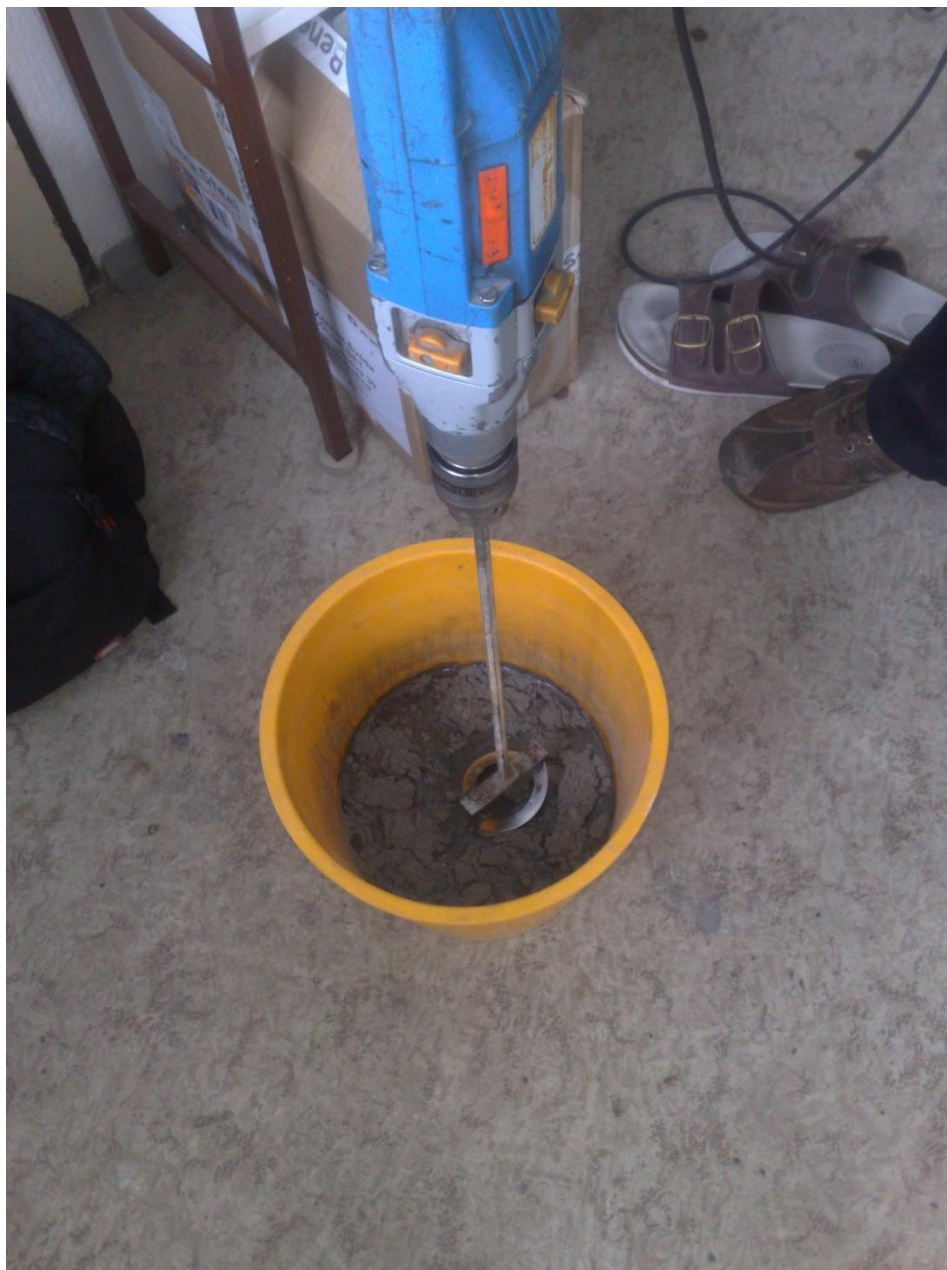
Obr. 5 – Míchání roztoku (NaOH, vodní sklo) s elektrérenským popílkem
