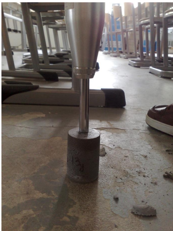
Obr. 11 – Zkouška tvrdosti – Schmidtovo kladívko
