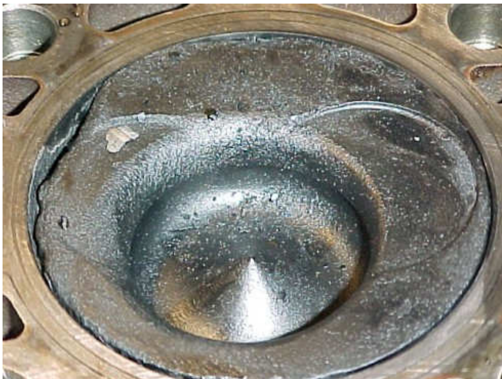
Obr. 1.02 Poškozený píst motoru po nekvalitním chiptuningu [11]
