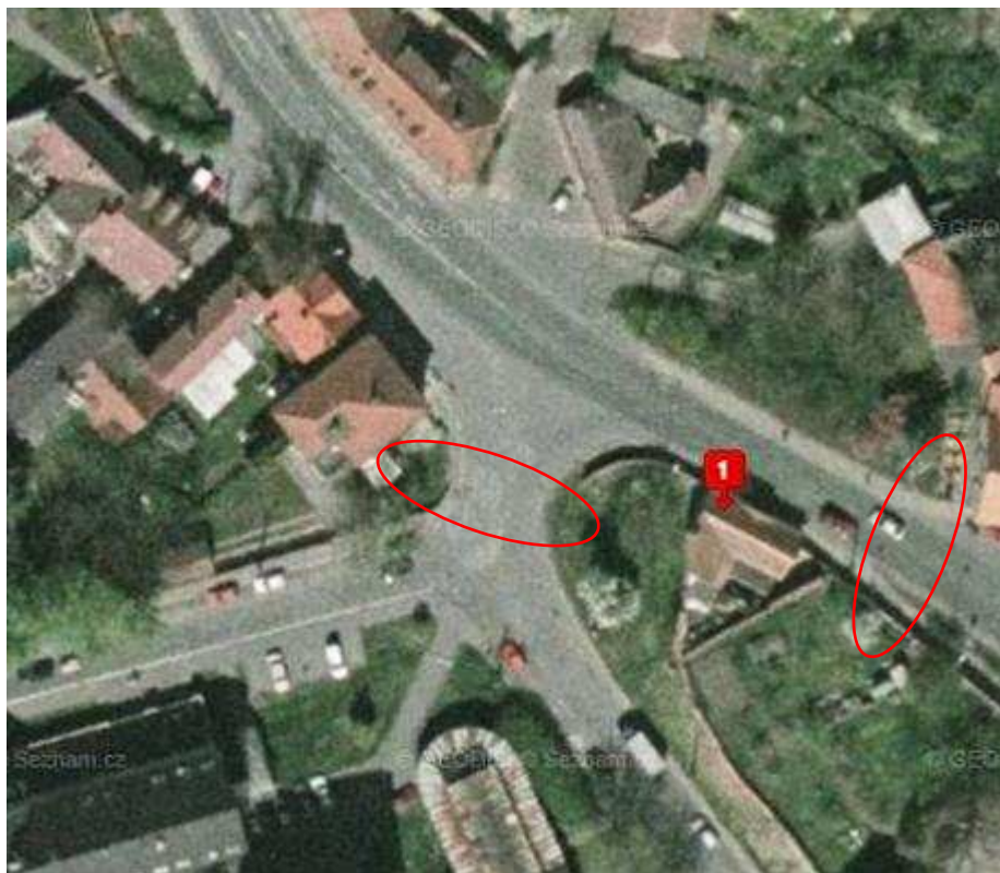
Obr. 5 – Křižovatka Střed – absence přechodu pro chodce v ulici Jilemnického a na křižovatce, absence chodníku k přechodu v křižovatce
