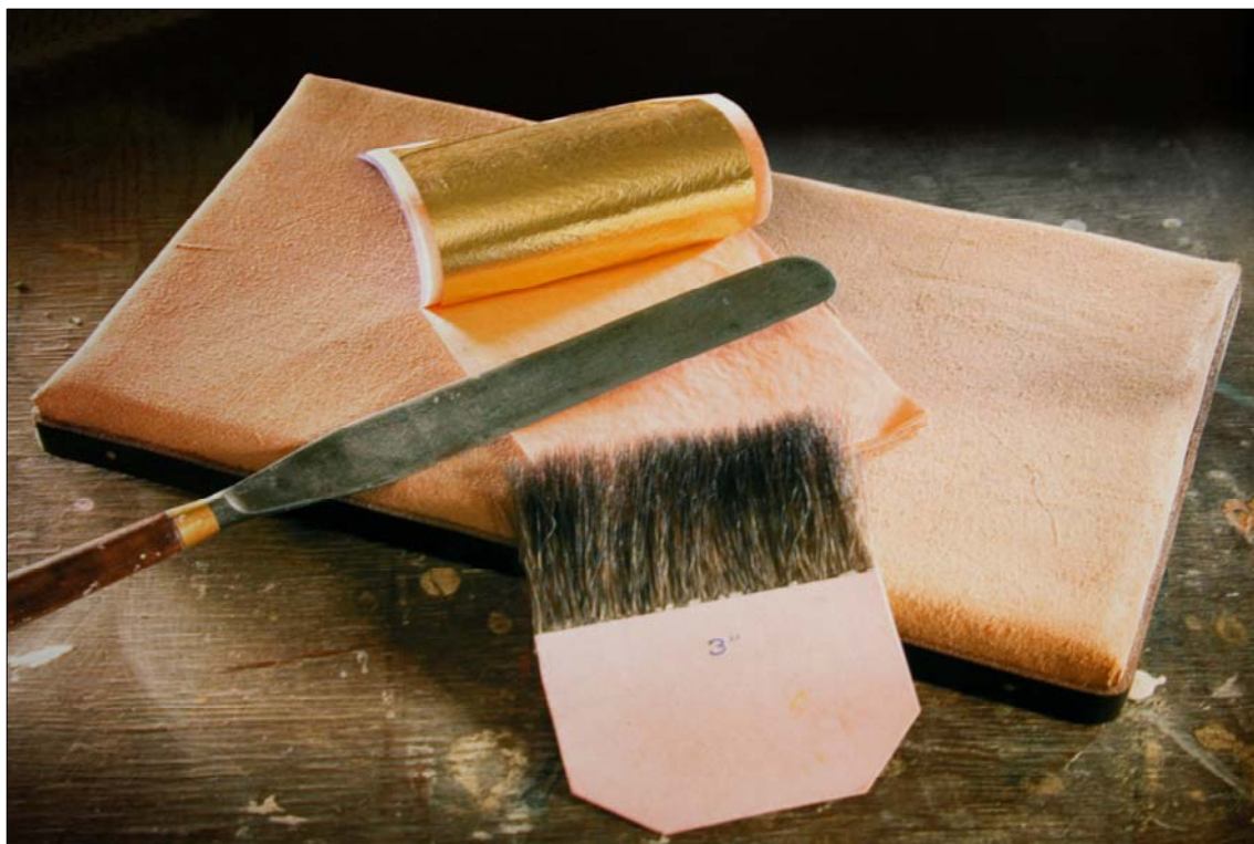
Obr. č. 26 Nářadí: pozlacovačský nůž a polštářek, pokládací. Foto: Gold Gilding History and Techniques
