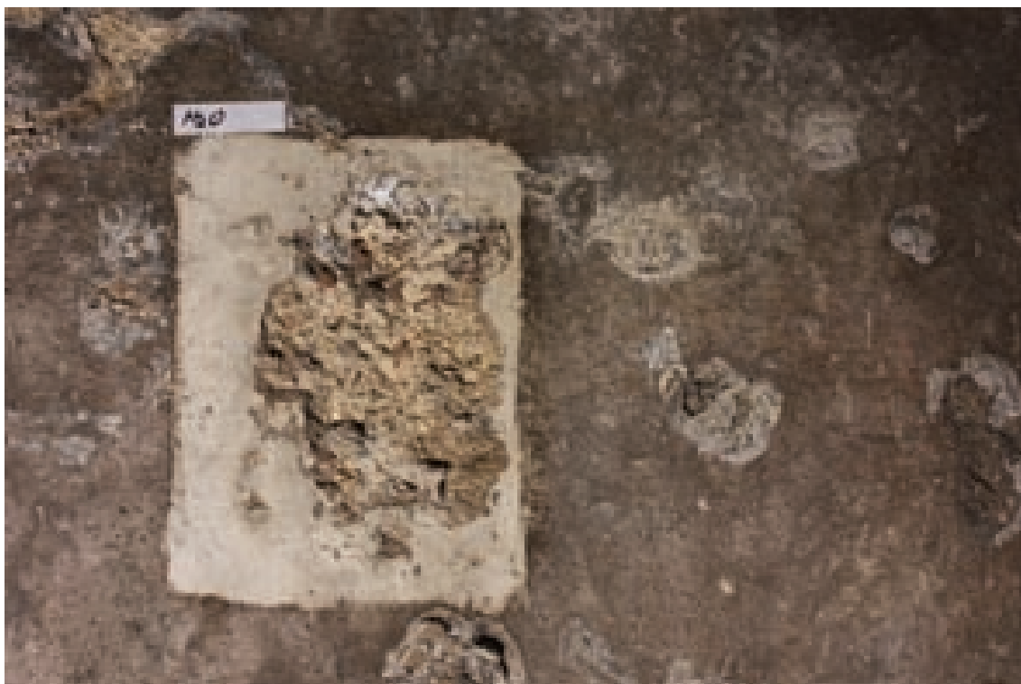
48. Zkouška snímání povrchových nečistot na barokní omítce - omytí vodou za pomoci mikroporézní houby
