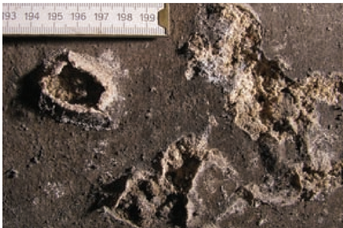
40. Krátery v barokní omítce způsobené činností vodorozpustných solí
