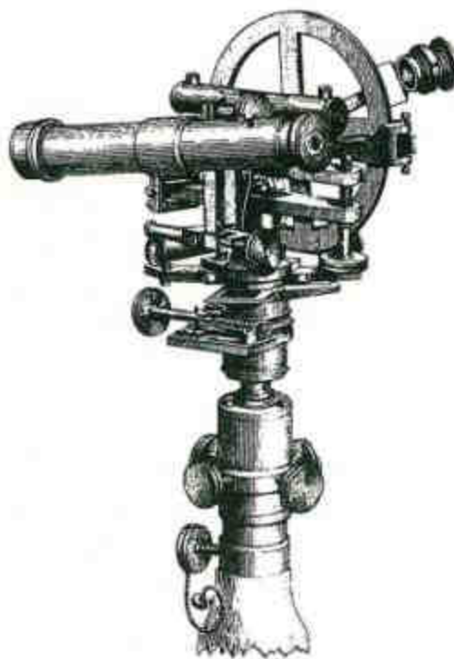
Obr. č. 216: Výškoměr topografa používaný po r. 1878.
