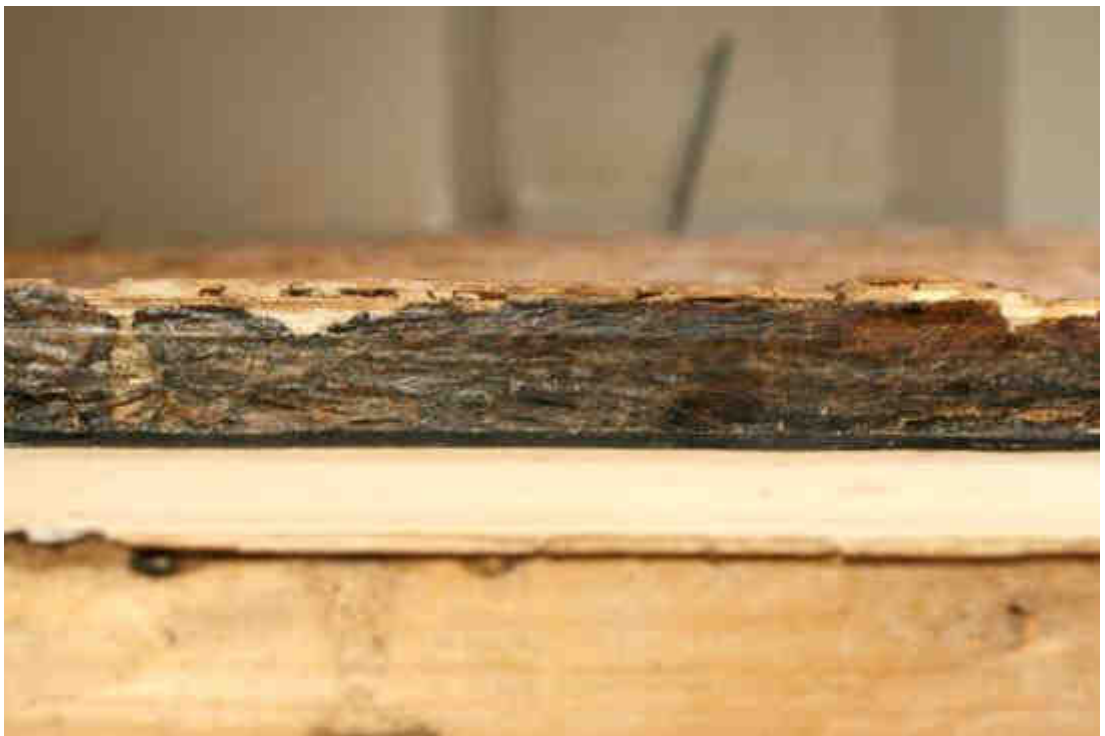
Obr. č. 95: Stav po zažehlení papíru na hranách, boční detail, denní rozptýlené světlo.
