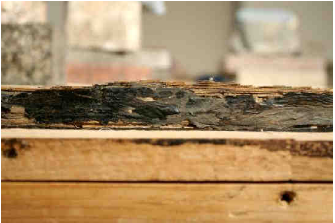
Obr. č. 94: Stav po zažehlení papíru na hranách, boční detail, denní rozptýlené světlo.
