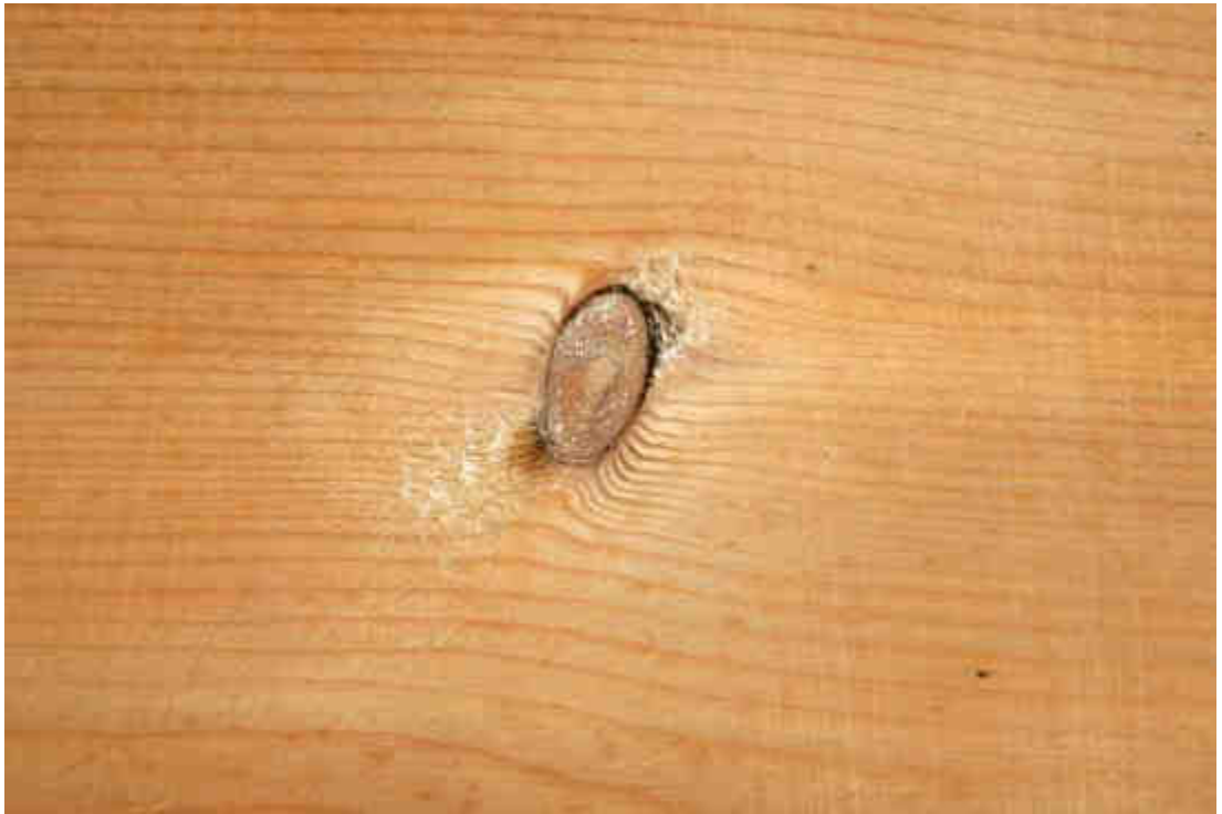
Obr. č. 174: Stav po odstranění starých tmelů, detail zadní strany, denní rozptýlené světlo.
