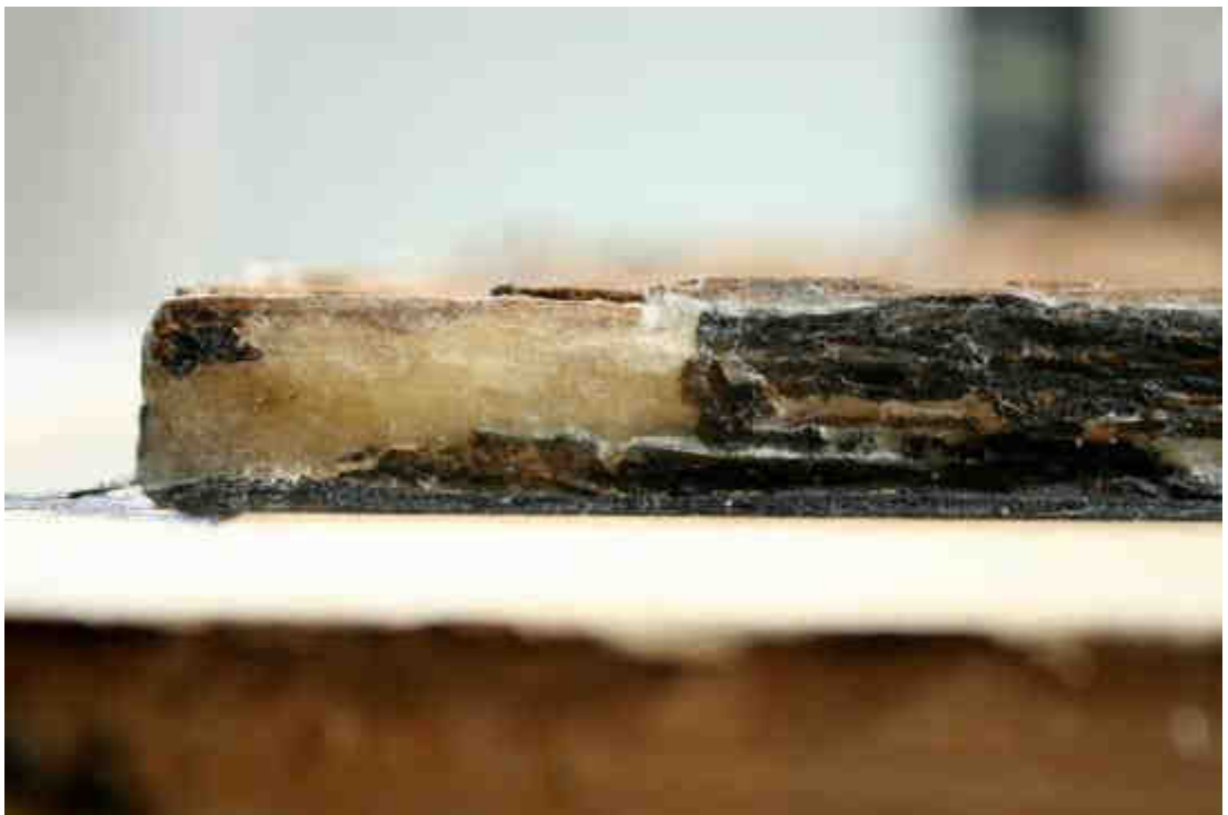
Obr. č. 103: Stav po tmelení hrany voskem, boční detail, denní rozptýlené světlo.
