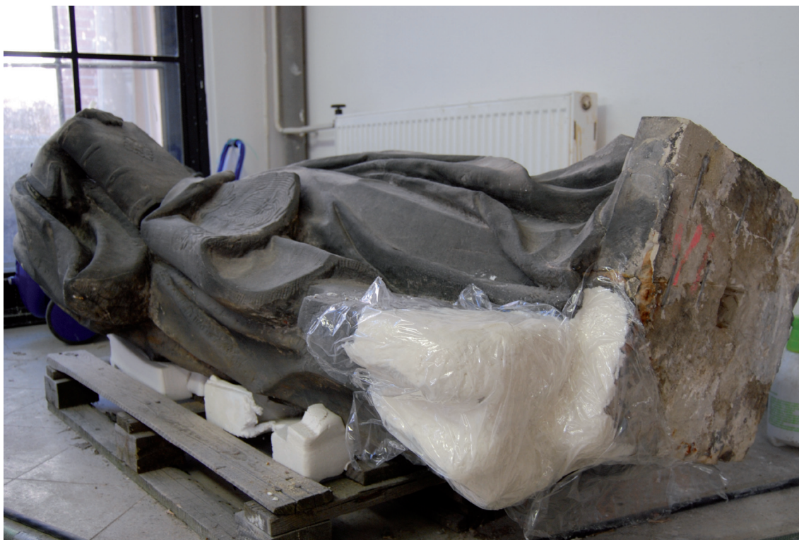
Obr. 24 - Lokální zábal z buničiny a destilované vody na místě výskytu vodorozpustných solí
