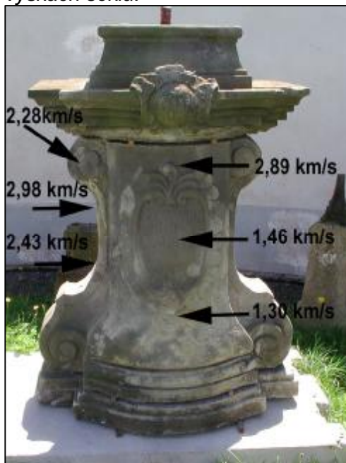
Obr. 8. Sokl pod sochou sv. Metoděje s naměřenými rychlostmi UZ v různých výškách soklu.
