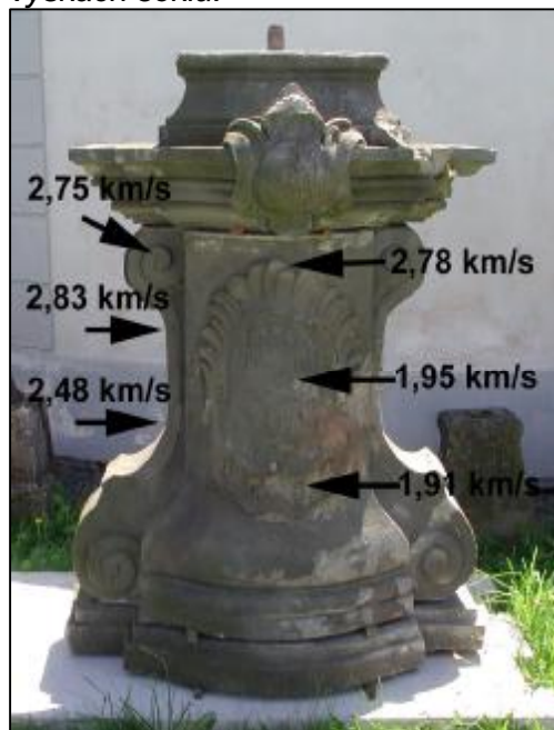
Obr. 7. Sokl pod sochou sv. Adalberta s naměřenými rychlostmi UZ v různých výškách soklu.
