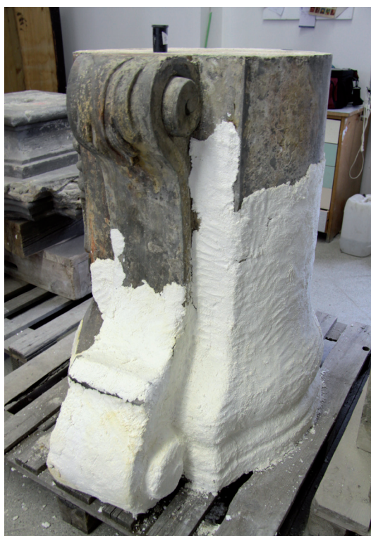
Obr. 39 - Buničinový zábal aplikovaný po vakuovém odsolování na místech podstavce, kde bylo riziko výkvětu vodorozpustných solí
