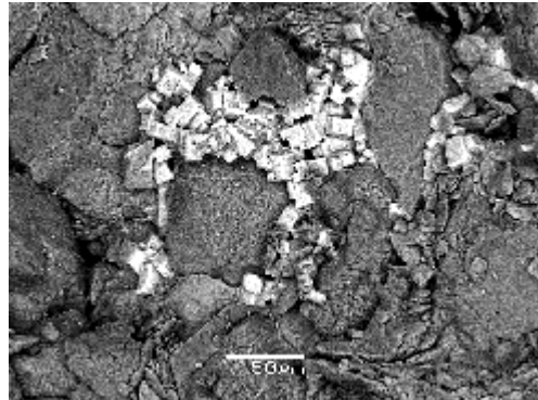
Obr.5. Mikrofoto REM-BEI, foto v režimu odražených elektronů, korodované místo s dobře viditelnými krystaly chloridu sodného, detail
