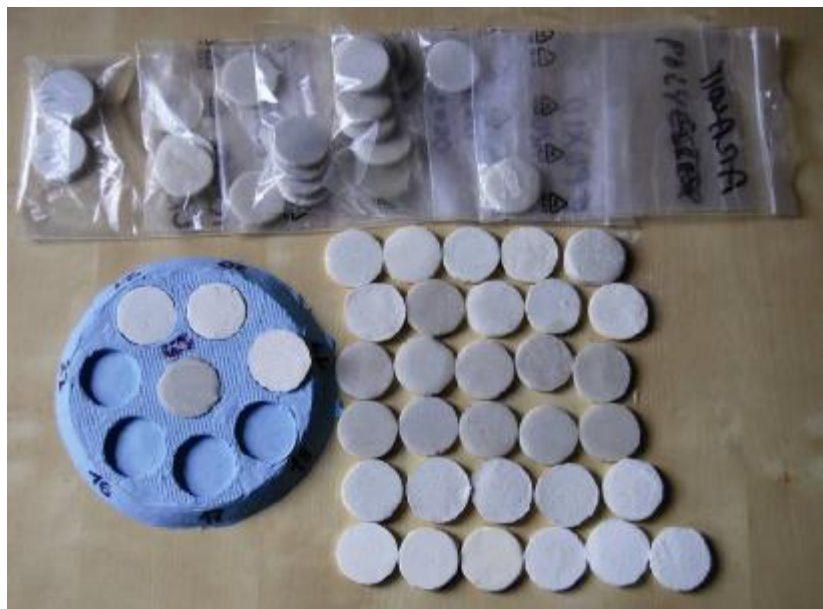
Obr. 7 – Předpříprava různých směsí vzorků, silikonová vzorkovnice používaná pro jejich výrobu
