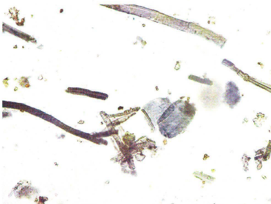
obr.8 Vzorek 3 – fragmenty vláken, přítomny i oválné parenchymatické buňky - vybarveno Graffovým „C“ činidlem
