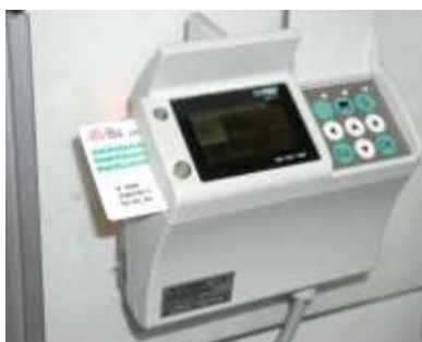
Obr. 8 OBU jednotka používaná v systému LSVA [9]
