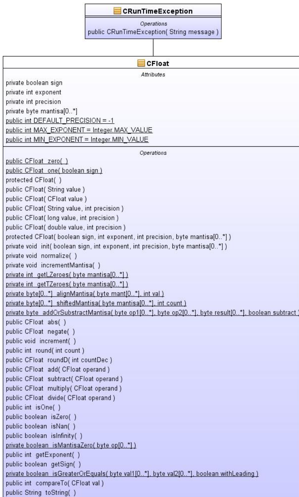
Obrázek 7 - Diagram tříd v balíčku applicationlayer, zdroj: vlastní
