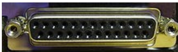
Obrázek 3: Konektor DSub 25 na straně PC
