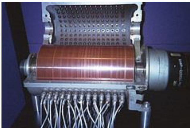
Obrázek 3 – Bubnová paměť po otevření krytu
