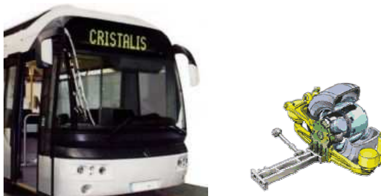
Obr. 2.19 Autobus Cristalis s ukázkou řešení nápravy
