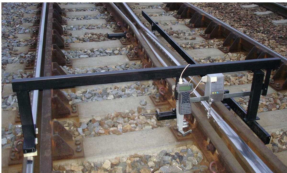
Obr. 19 Systém pro měření příčných profilů srdcovek
