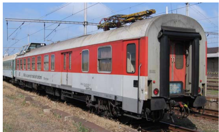
Obr. 35 Měřicí vůz pevných trakčních zařízení
