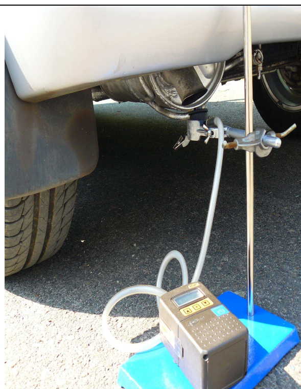
Obr. 6 Odběr vzorků přístrojem AirChek [vlastní foto]
