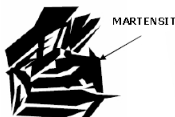
Obr. 6: Mikrostruktura MS oceli [8]
