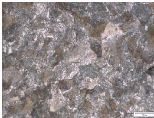
Obrázek 48 - Broušený vzorek žíhaný (zvětšení 800x) -(perlit) [autor]
