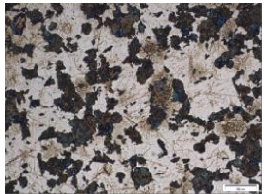
Obrázek 52 - Broušený vzorek kalený (zvětšení 800x)- břit (martenzit s ostrůvky bainitu) [autor]
