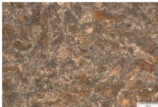
Obrázek 44 - Kovaný vzorek (zvětšení 800x)-břit -(perlit) [autor]
