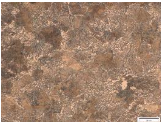
Obrázek 47 - Kovaný vzorek žíhaný (zvětšení 800x) -(feriticko-perlitická struktura) [autor]
