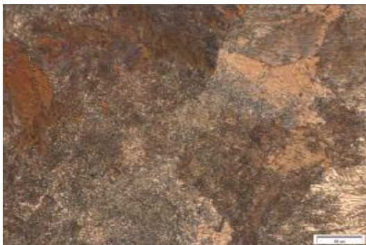
Obrázek 43 - Kovaný vzorek (zvětšení 800x)-zákl -(perlit) [autor]
