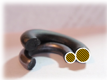
Obrázek 18: Detail zvětšení průřezu pryžového těsnění
