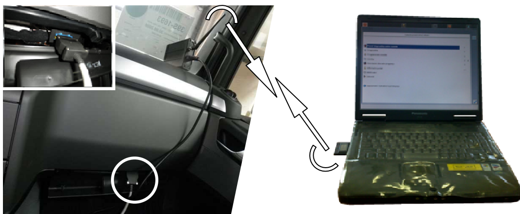
Obrázek 24: Diagnostický tester MAN-cats II připojený ve vozidle MAN TGX
