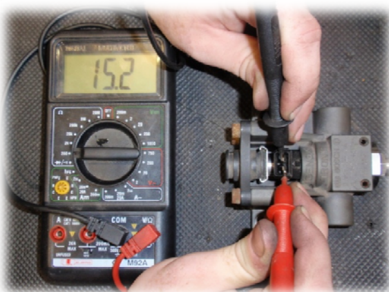
Obrázek 29: Ilustrace z měření rezistence dávkovacího modulu
