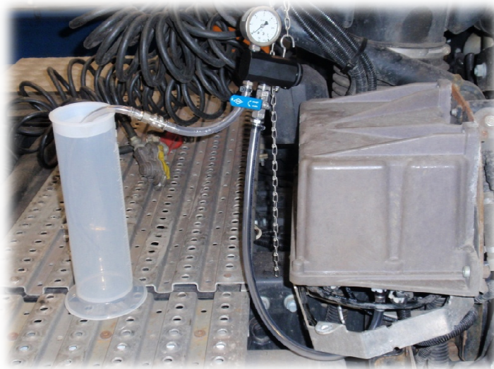
Obrázek 28: Ilustrace z měření čerpacího výkonu modulu
