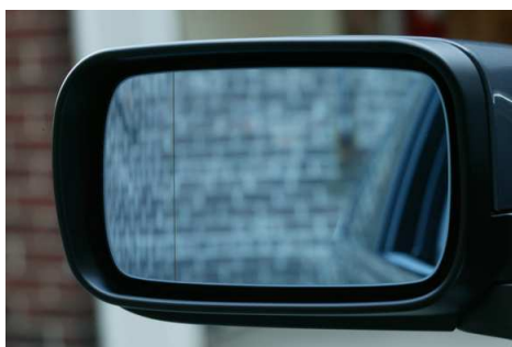
Obr. 19: Asférické zpětné zrcátko – jednoduchý prvek aktivní bezpečnosti
