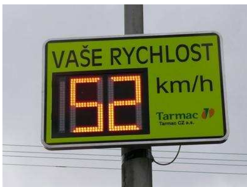
Obr. 28: Informační radar ukazující aktuální rychlost umístěný v obci
