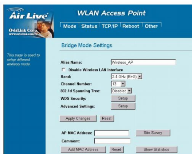
Obrázek č. 35: Nastavení bridge
