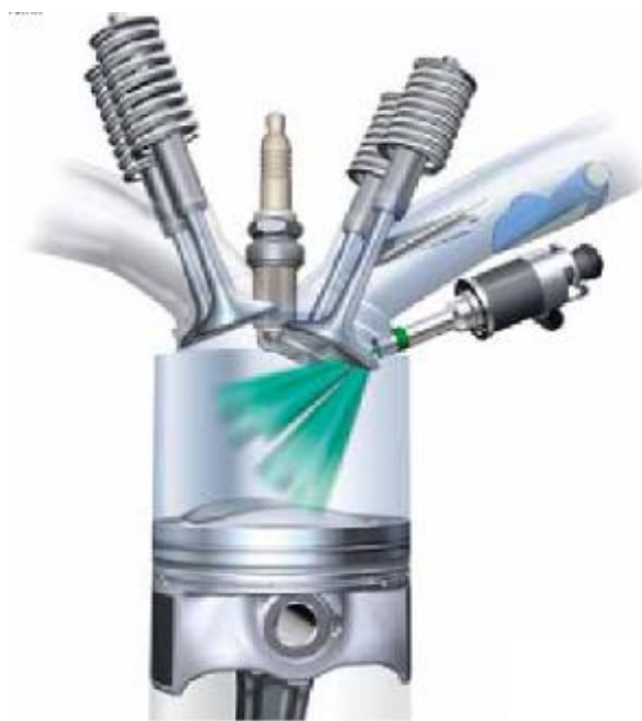
Obrázek 12 – Pozice vstřikovacího ventilu v hlavě motoru
