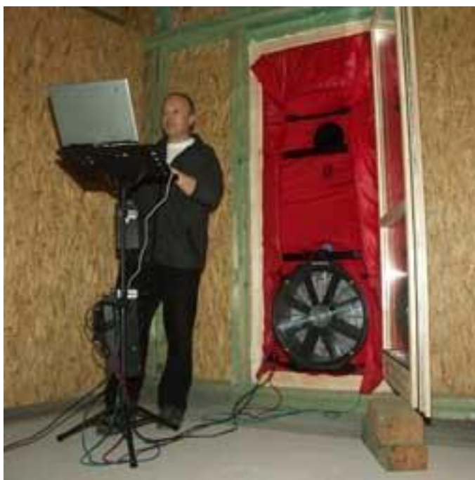
Obrázek č. 10: Blower door test 59
