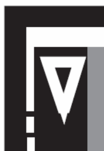
Obr. 28 Příčná čára souvislá se symbolem „Dej přednost v jízdě“ (č.V 6a )
