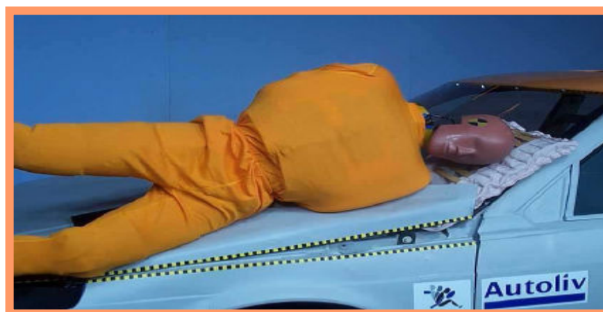
Obrázek 9 Airbag pro chodce Zdroj: FordPressCentrum
