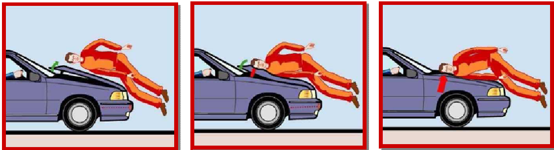
Obrázek 10 Srážka chodce a automobilu s aktivní kapotou Zdroj: NissanPressCentrum
