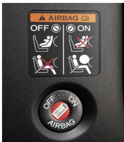
Obrázek 11 Zapínání airbagu u spolujezdce Zdroj: HondaPressCentrum
