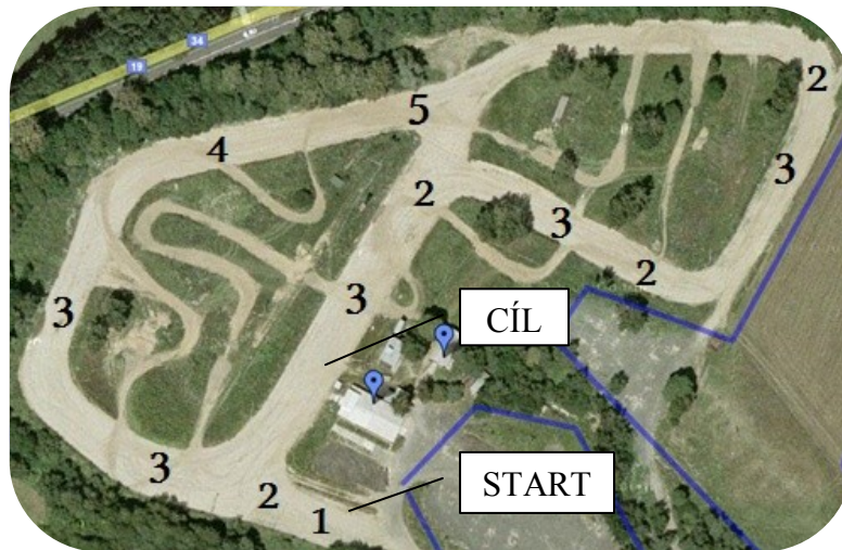
Obr. 3.15 Profil tratě s jednotlivými rychlostními stupni [13]
