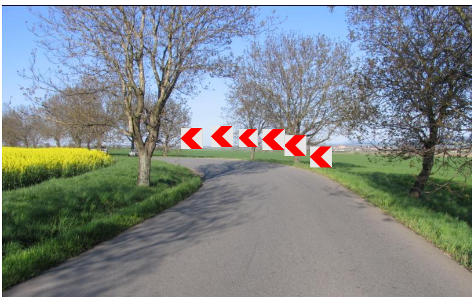
Obrázek č. 35: Návrh zvýraznění nebezpečného směrového oblouku
