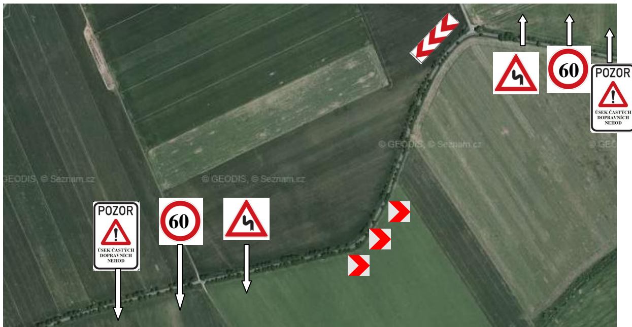
Obrázek č. 38: Návrh řešení nehodového místa č. 3
