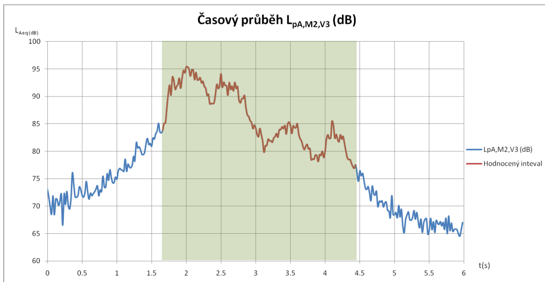
Obrázek 18 - Stanovení intervalu měření v záznamu hladiny hluku, měřeno mikrofonem M_2 , emitovaného projíždějícím vozidlem V_2
