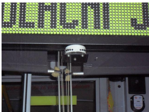
Obrázek 6 Čidlo inframajáku zdroj (autor)
