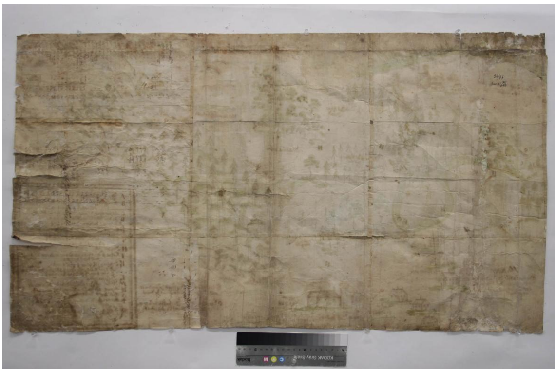
Obr. č. 74: Stav v průběhu restaurování, celkový pohled z reversu, po čisticím toluenovém obkladu.
